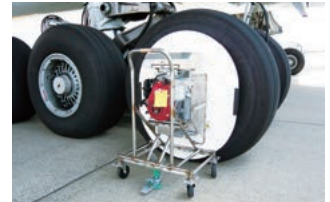
ブレーキクーリングカート (写真はガソリンエンジンを使用したBCCです。)
