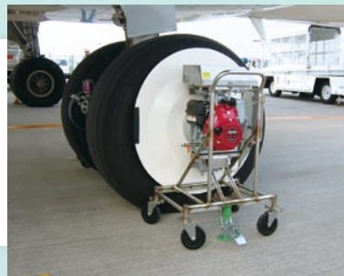
使用中のブレーキクーリングカート (写真はエアバスA320iに装着中)
