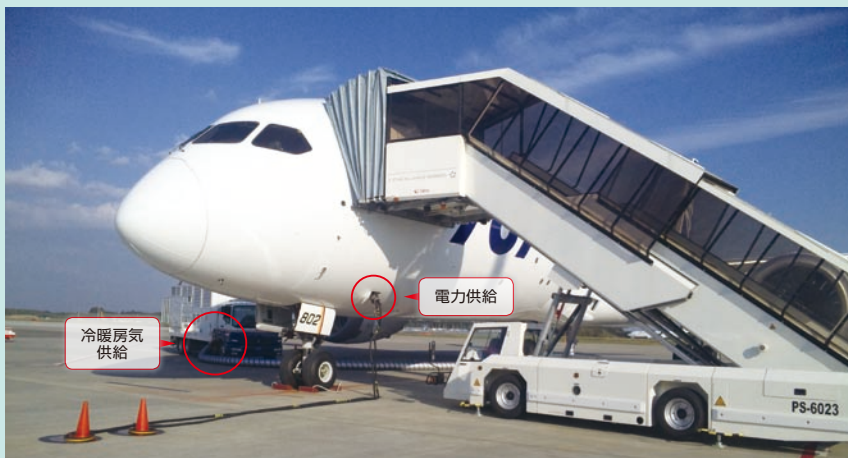
電力供給設備 (GPU) による電力供給とエアコン車による冷暖房気供給 (B787)
