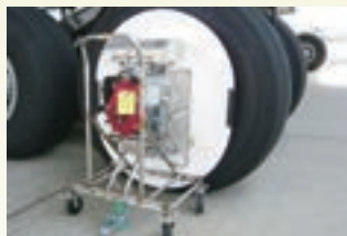
ブレーキクリーニングカート・運搬台車 航空機が到着して出発までの間の短い 時間でブレーキを冷却。日本での販売 実績は累計724台。
