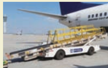
先端部伸長機構付ベルトローダー ハンドリング会社にてデモ機トライアル中
